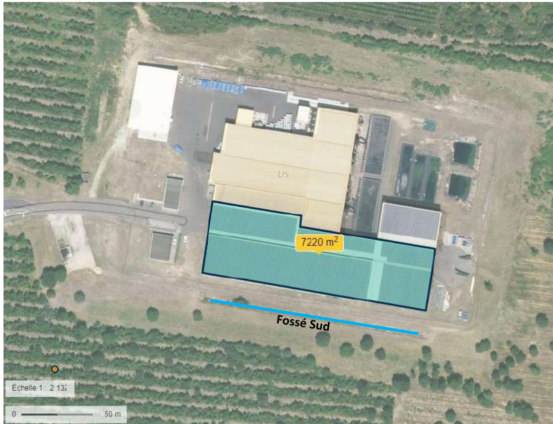
Figure 52 : Surfaces imperméabilisées collectées par le fossé d'infiltration Sud
